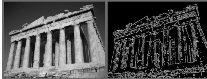
FIGUR 2.9: Eksempel på resultat af Canny metoden. (Bradski and Kaehler, 2008)
