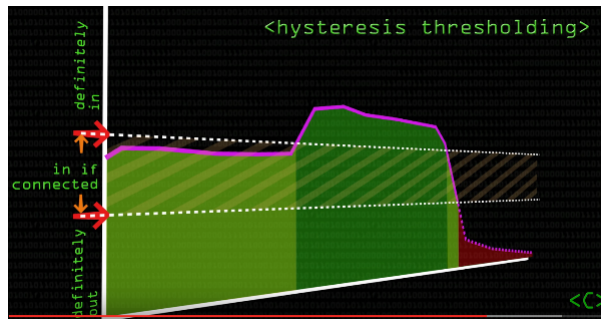
FIGUR 2.8: Billedet illustrerer en 1D repræsentation af en kant på et billede, hvorpå der bliver udført hysteresis tærskling. Langs x-aksen ses en kant og på y-aksen ses kantens intensitet. Kanten er annoteret med en lilla streg og hysteresistærsklerne er annoteret med hvide stiplede linjer. Den del af kanten som ligger over tærsklen, bliver registreret som et kantstykke. Den del der ligger i det skraverede område imellem de to tærskler vil, fordi det ligger i forlængelse af et registreret kantstykke, også blive registreret som et kantstykke. Den sidste del af kanten, som ligger under tærsklen, vil ikke blive registreret som et kantstykke.
