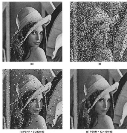
FIGUR 2.3: Øverst til højre ses det originale billede. Billedet bliver påført 'salt og pepper'-støj. På de to nederste billeder ses det hvordan Median-sløring fjerner støjen og bevarer billedet. ('Salt and Pepper' noise reduction)
