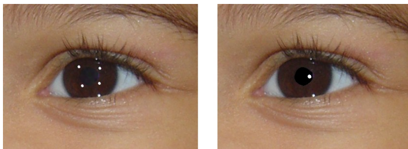
Figura 7: Exemplo do efeito da iluminação com quatro LEDs e o polígono criado na pupila do indivíduo
