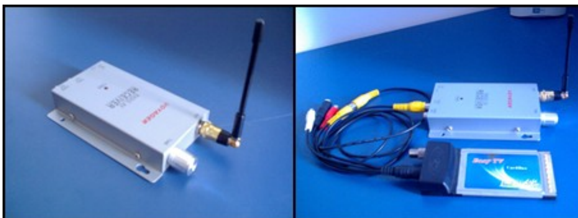
Figura 25: Instalação do receptor de vídeo e áudio ( wireless ) com a placa de captura de vídeo ( framegrabber )
